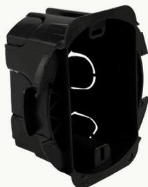
A Caixa 4x2 Espadi para alvenaria estrutural é projetada para a instalação elétrica de tomadas e interruptores, oferecendo uma solução rápida e prática. Com cinco entradas para eletrodutos de  $\frac{3}{4}$ " e uma para eletroduto de 1", esta caixa é compatível com qualquer acabamento do mercado e é desenvolvida em conformidade com a norma técnica NBR 5431. Além da caixa, temos a tampa como acessório para proteção dos componentes durante a obra até a instalação final do acabamento.
